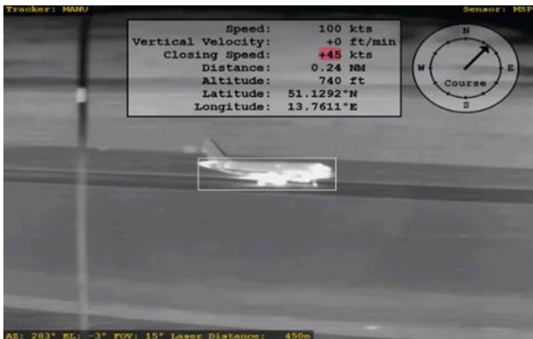
Abbildung 3: Darstellung eines selektierten Zieles im Infrarotbereich
