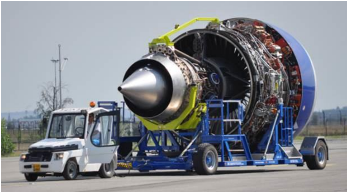
Rolls Royce Trent XWB Triebwerk auf einem Transportwagen (Quelle: Rolls Royce)
