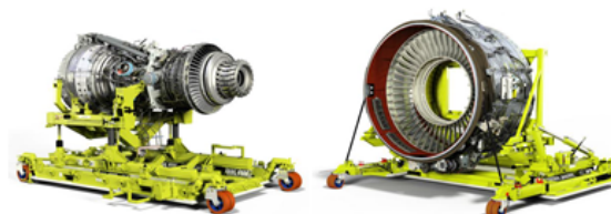
Rolls Royce Trent XWB Triebwerk - Nachweis Logistikkonzept (Quelle: Rolls Royce)
